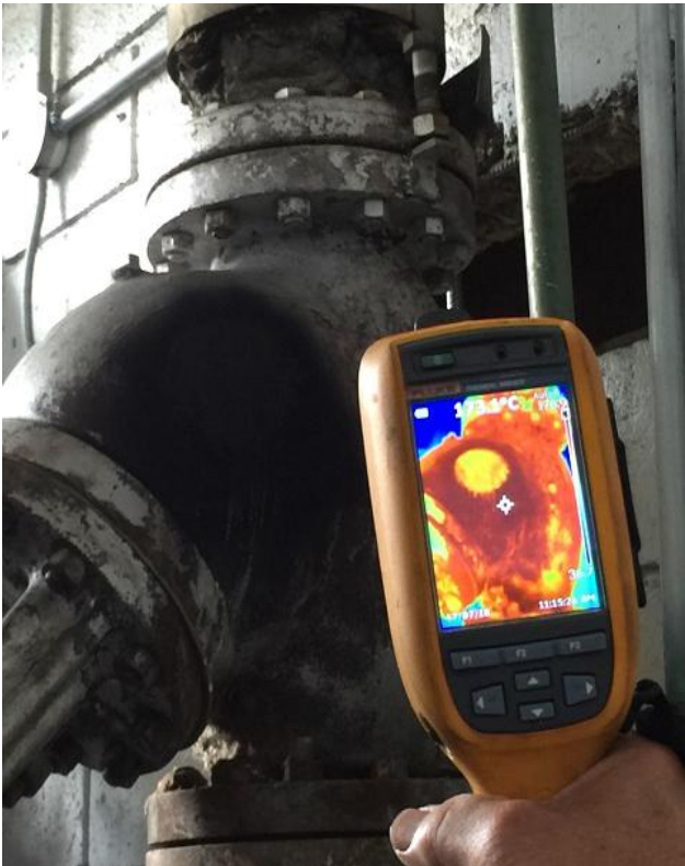
Foto-7: temperatura sobre zona sin T-260 =173.1°C; Foto-8: temperatura sobre zona con T-260 =129.0°C.
