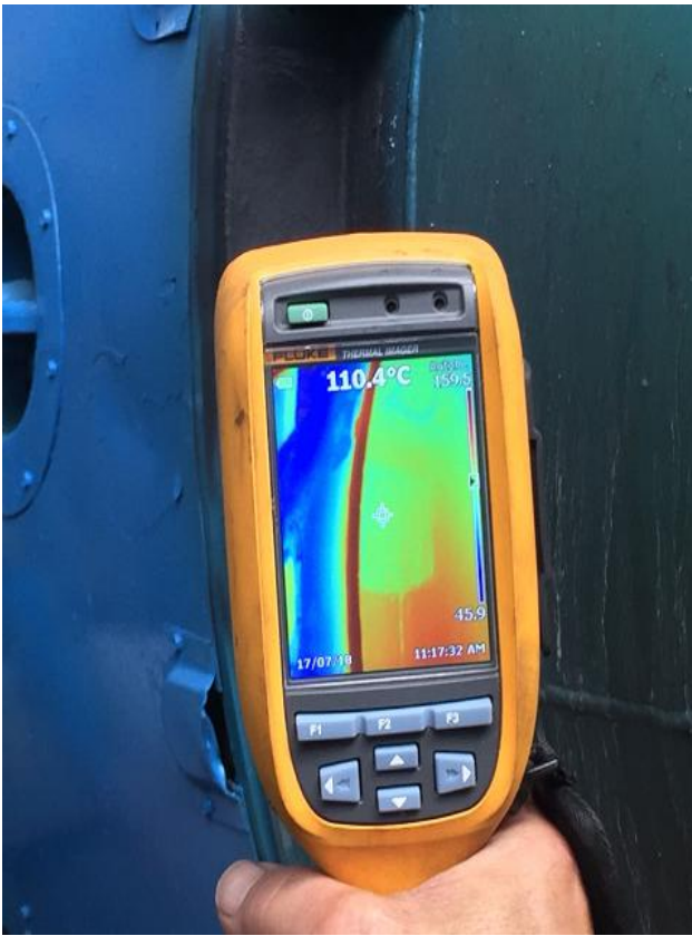
Foto-9: temperatura sobre zona con T-260 =110.4°C; Foto-10: temperatura sobre zona sin T-260 =136.6°C.
