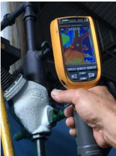
Foto-11: temperatura sobre zona sin T-260 lado vapor =171.5°C; Foto-12: temperatura sobre zona sin T-260 lado agua =136.4°C; ; Foto-13: temperatura sobre zona con T-260 lado agua lado línea de nivel =122.7°C.
