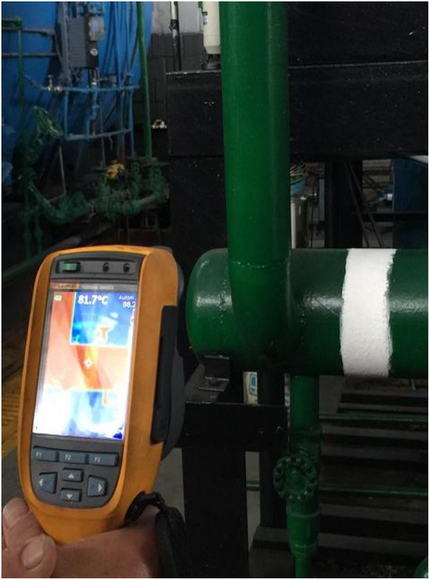
Foto-5: temperatura sobre zona con T-260 = 81.7°C; Foto-6: temperatura sobre zona sin T-260 =86.4°C.
