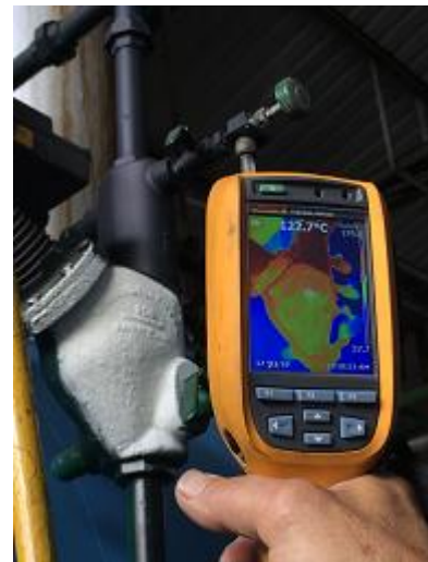
Foto-11: temperatura sobre zona sin T-260 lado vapor =171.5°C; Foto-12: temperatura sobre zona sin T-260 lado agua =136.4°C; ; Foto-13: temperatura sobre zona con T-260 lado agua lado línea de nivel =122.7°C.
